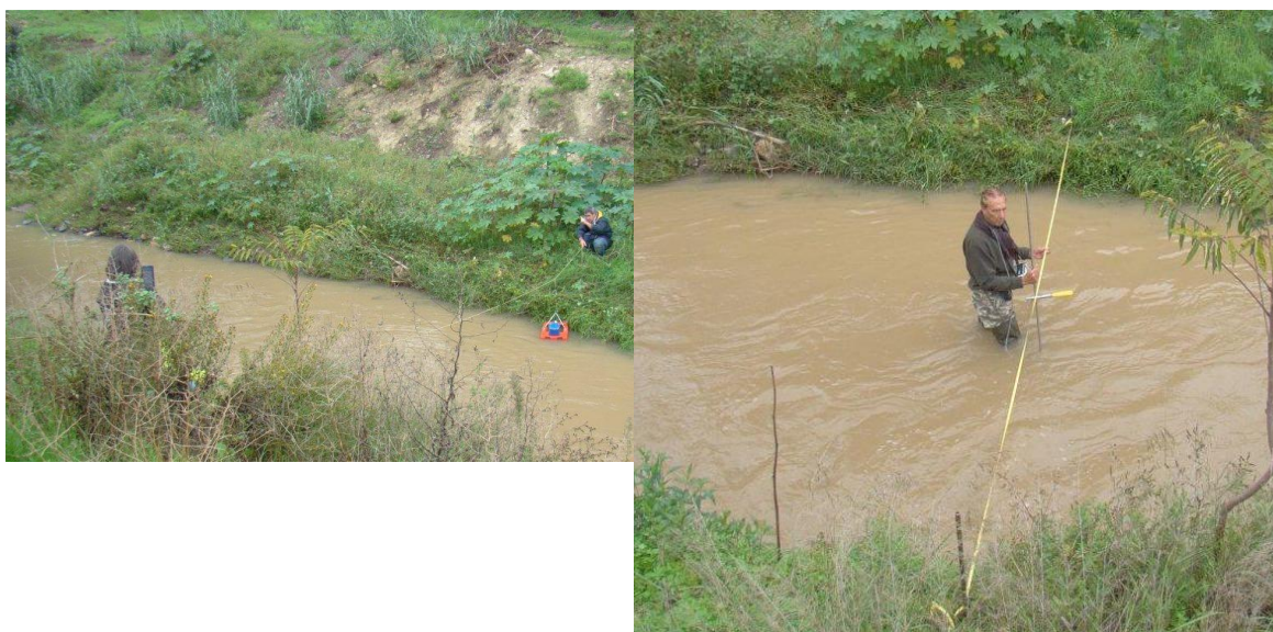
Figura 3 – Medição de caudal com o StreamPro e com medidor electromagnético
